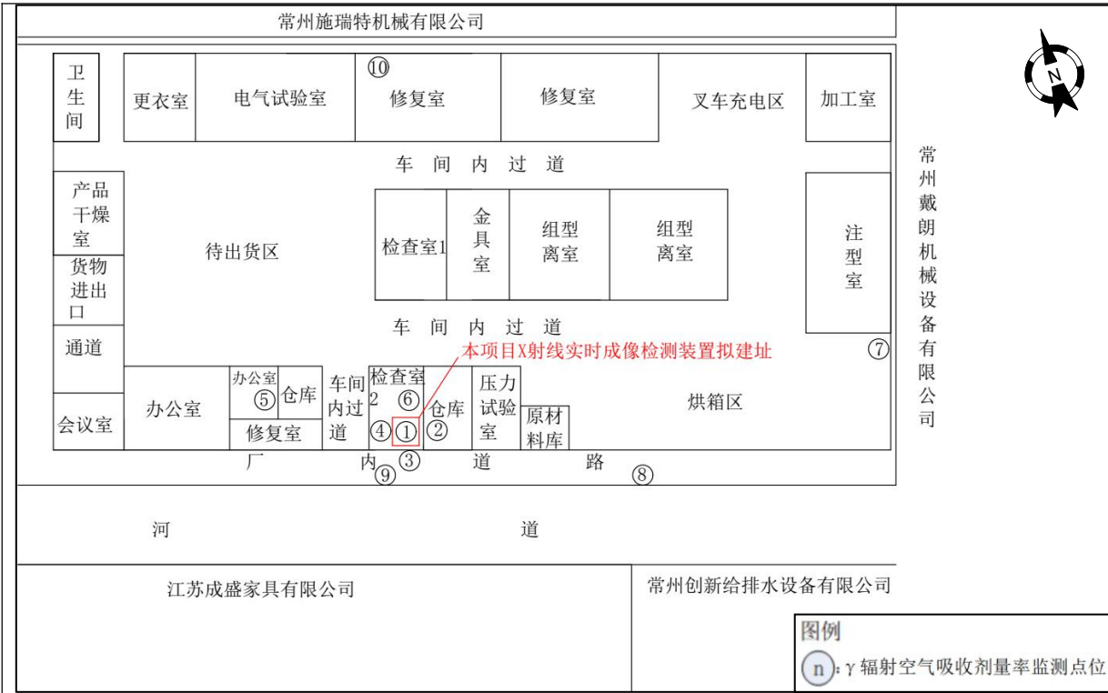
图 8-2 本项目 X 射线实时成像检测装置拟建址周围环境 \gamma 辐射空气吸收剂量监测点位示意图
