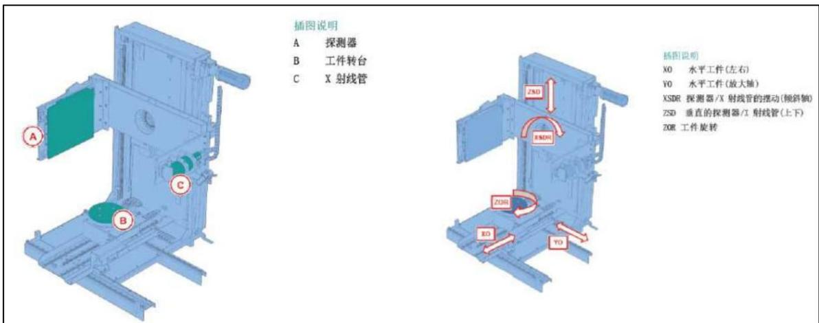
图 9-4 6#工业 CT 装置内部结构示意图
