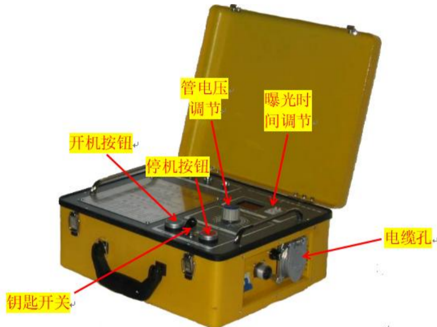
图9-2 常见X射线探伤装置控制箱
