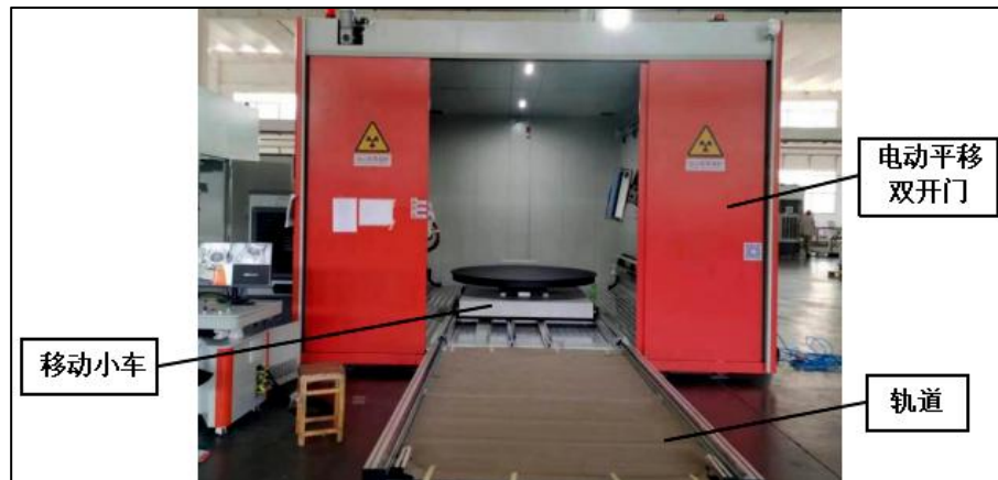
图 9-4 X 射线数字成像检测系统结构实物图
