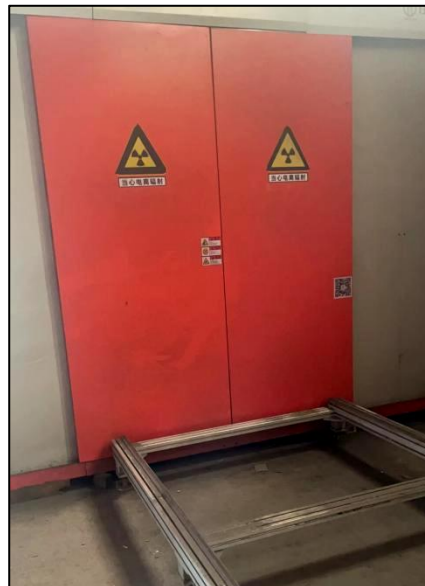
图 9-5 X 射线数字成像检测系统工件门处轨道细节图
