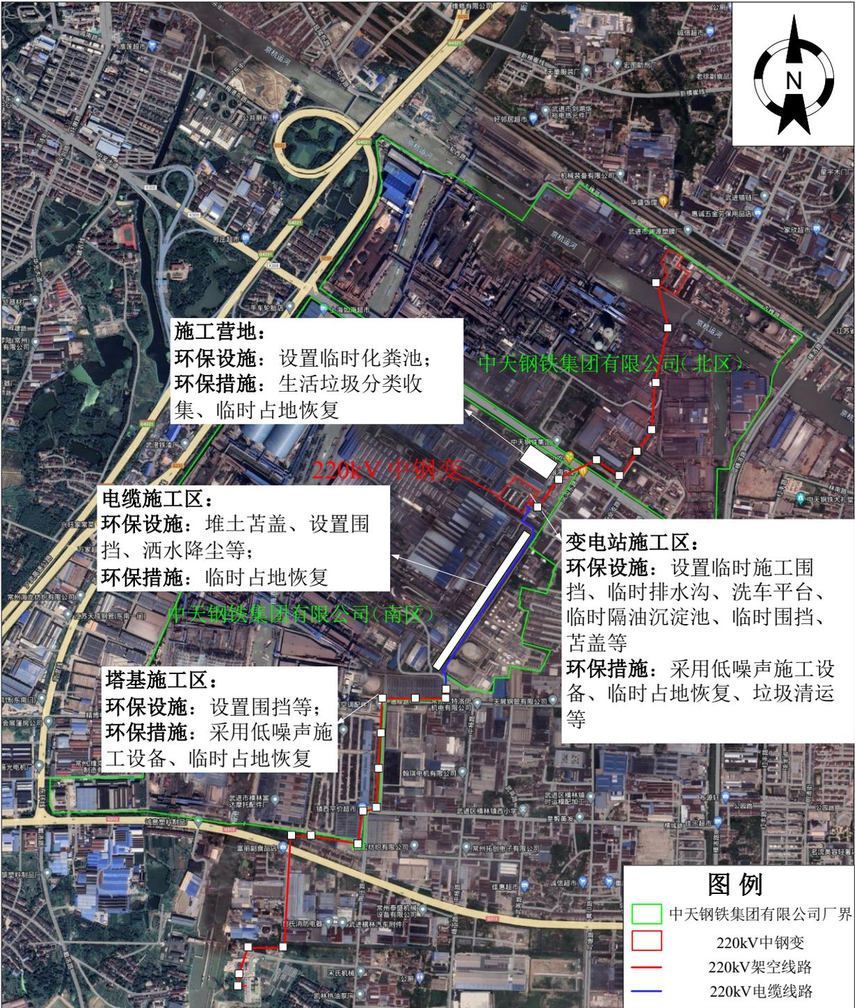
附图 6 本项目施工现场布置及施工期环保设施、措施示意图
