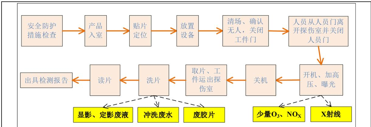
图 9-3 X 射线探伤机探伤工作流程及产污环节分析示意图
