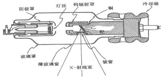
图 9-2 典型的 X 射线管结构图
