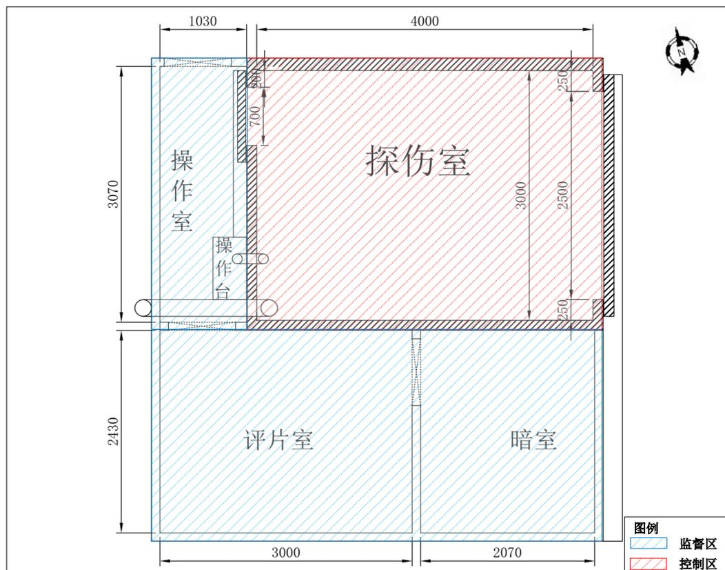
图 10-1 本项目 X 射线探伤铅房平面布局及分区图
