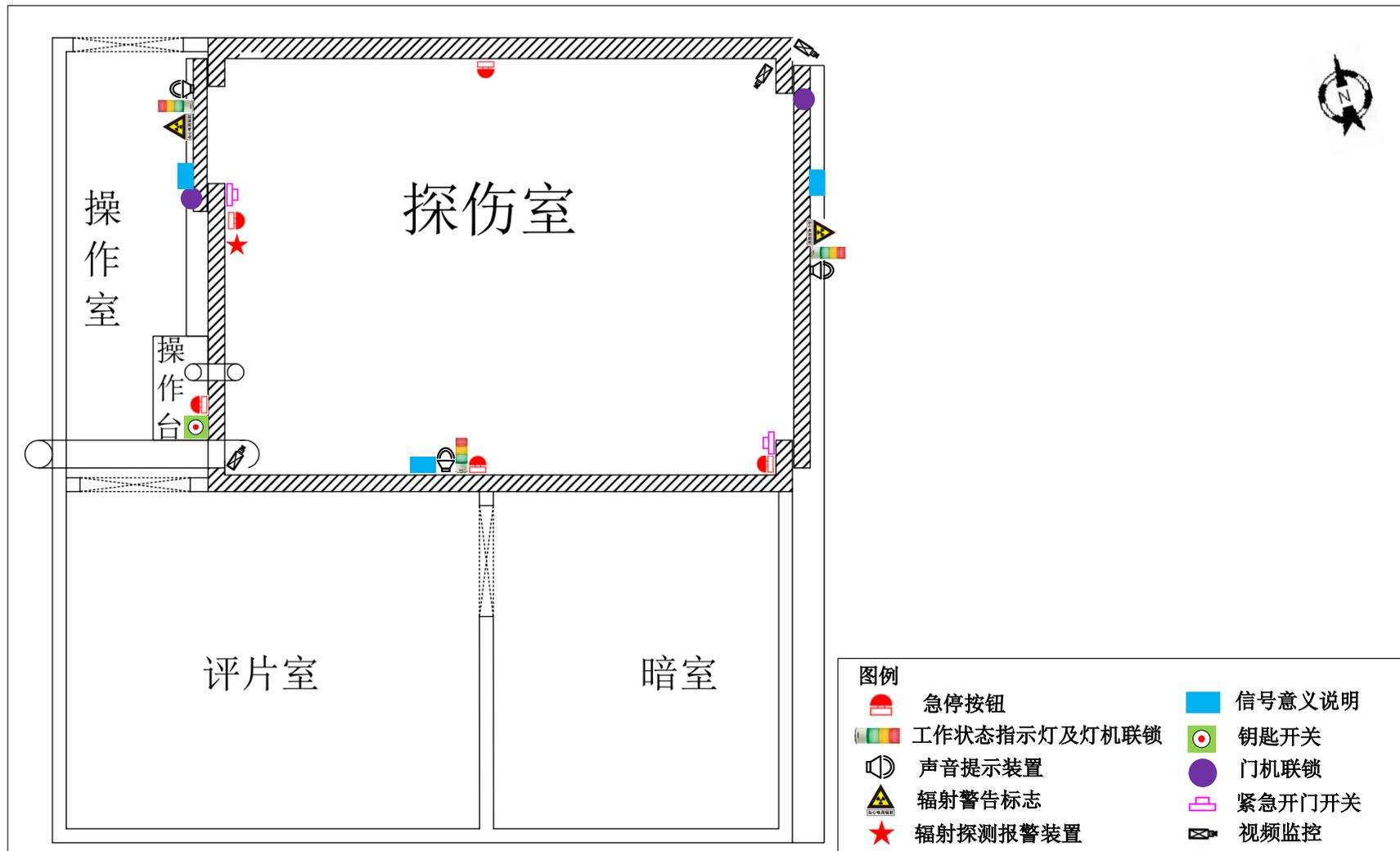
附图 5 本项目 X 射线探伤铅房辐射安全措施示意图
