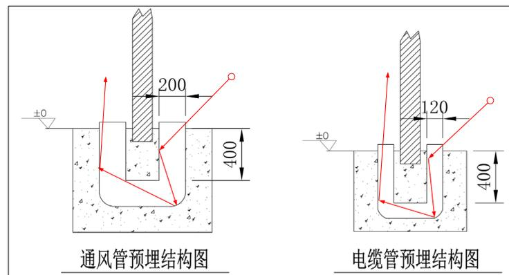
图 11-2 通风管道、线缆管道散射示意图
