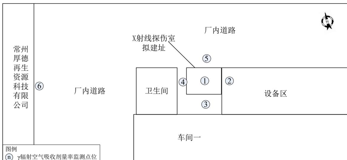
图 8-2 本项目 X 射线探伤室拟建址周围环境  $\gamma$  辐射空气吸收剂量率监测点位示意图
