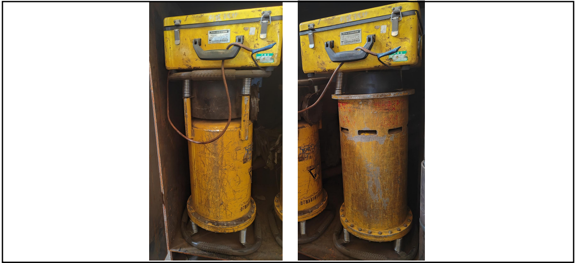
图 9-2 本项目原有 X 射线探伤机外观图及连接电缆
