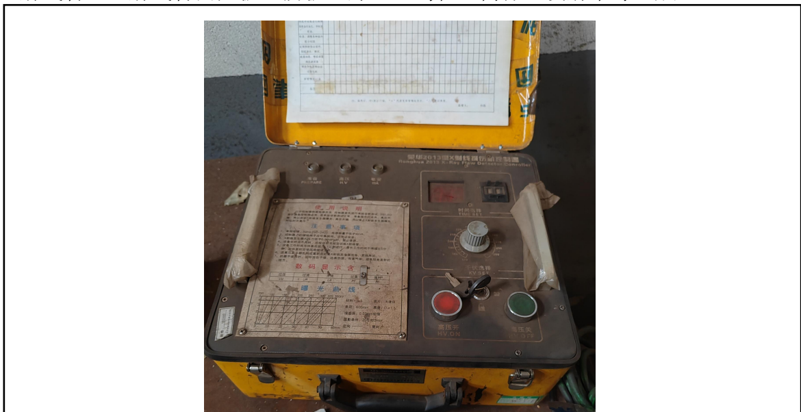
图9-1 本项目原有X射线探伤装置控制箱
