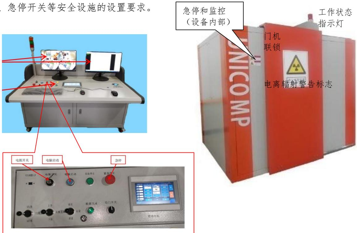
图10-3装置辐射安全设施位置示意图
