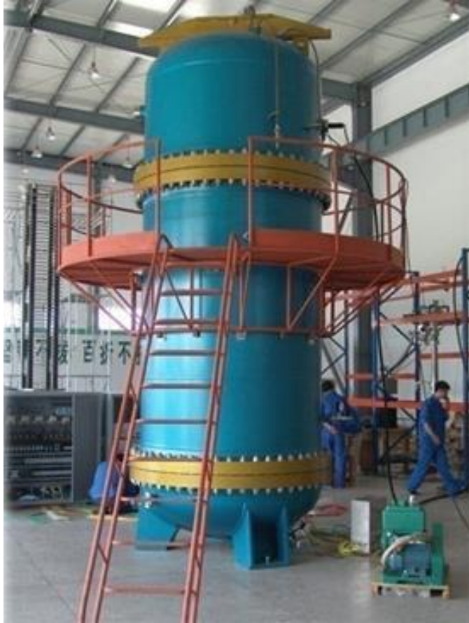
图 9-1 AB 型电子加速器辐照装置外观
