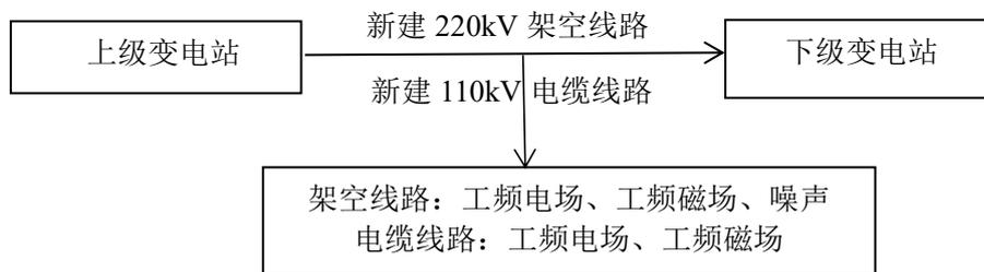
图 4.2 运行期工艺流程及产污流程图
