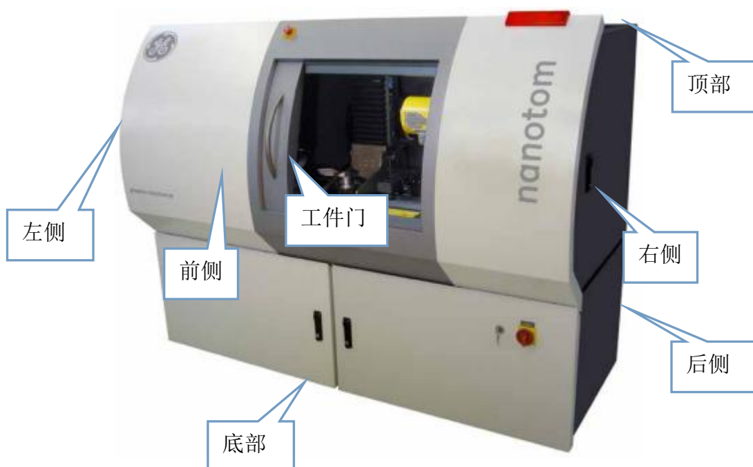
图 9-1 phoenix nanotom m180kv 型工业 CT 检测装置样式图
