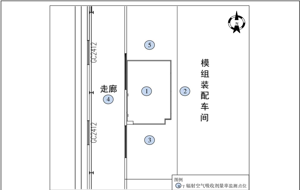
图 8-3 本项目老厂区工业 CT 装置拟建址周围环境  $\gamma$  辐射空气吸收剂量率监测点位示意图
