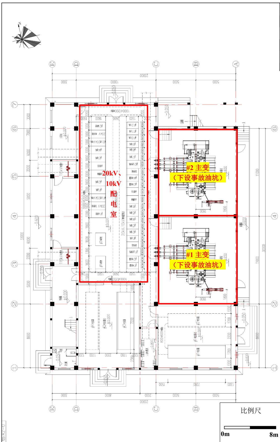
附图 4-1 常州合全药业有限公司 110kV 变电站工程一层平面布置示意图
